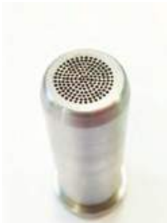
Wiercenie otworów w filtrze - 163 otworów \varnothing 0,45 \pm 0,05
