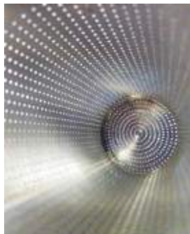
Wiercenie otworów w filtrze stożkowym - 2301 otworów \varnothing 0,3 \pm 0,03
