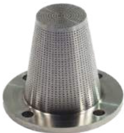
Wiercenie otworów w filtrze stożkowym - 2301 otworów \varnothing 0,3 \pm 0,03
