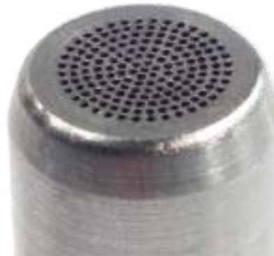
Wiercenie otworów w filtrze - 163 otworów \varnothing 0,45 \pm 0,05
